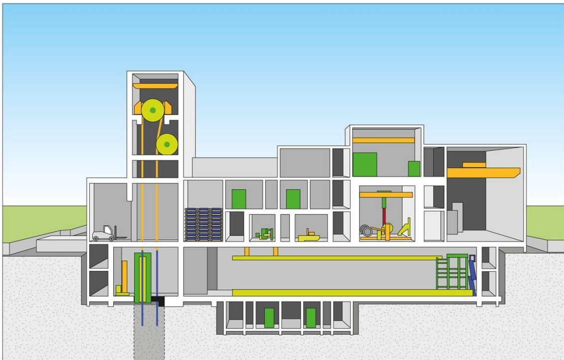
Abbildung A. 2: Schematischer Aufbau der Konditionierungsanlage des Endlagers für hochradioaktive Abfälle in Finnland (Posiva Oy o. J.-b)
